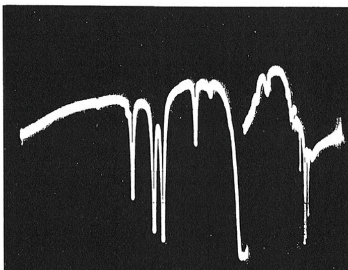
One inch Ge étalon calibration trace
